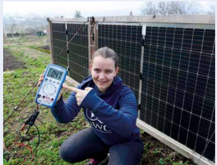
Genau nachgemessen: Hannah König misst nach, wie sich die Leistung des vertikalen Solarmoduls im Tagesverlauf verändert, und berechnet, wie sich das auf die Wirtschaftlichkeit auswirkt.
